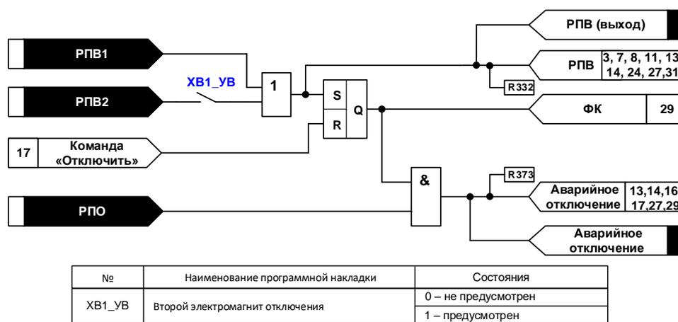
Рисунок 15 – Функциональная схема формирования сигнала аварийного отключения
