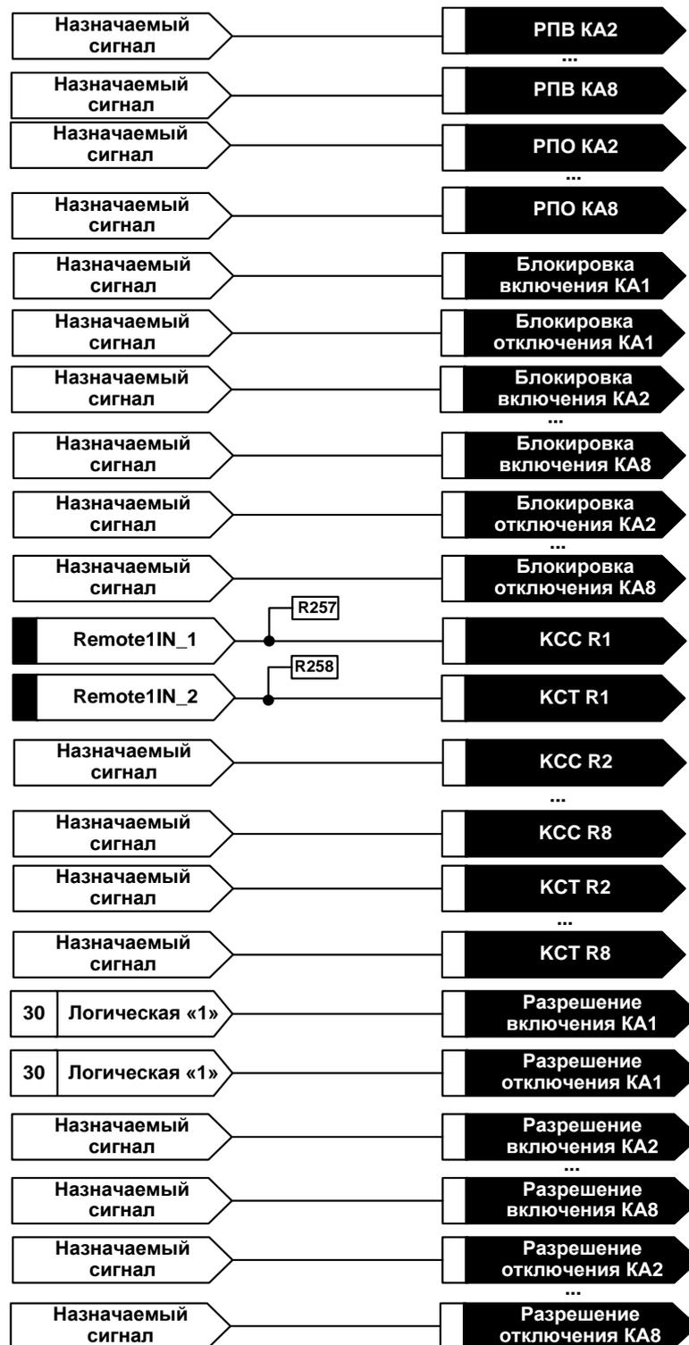
Рисунок 32 – Конфигурируемые входы для дистанционного управления коммутационными аппаратами
