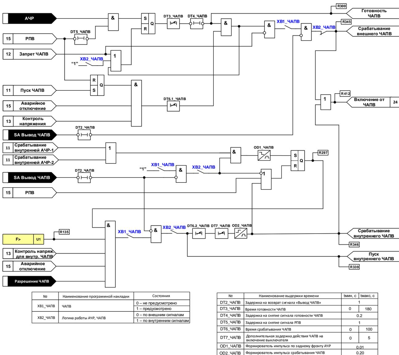
Рисунок 14 – Функциональная схема ЧАПВ
