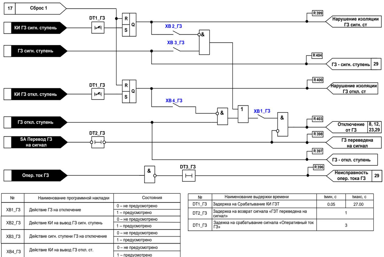
Рисунок 10 – Функциональная схема газовой защиты
