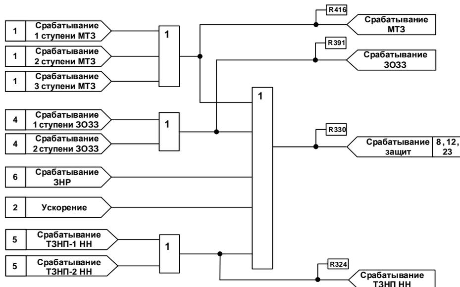
Рисунок 21 – Функциональная схема срабатывания защит
