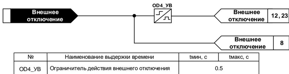
Рисунок 22 – Функциональная схема внешнего отключения
