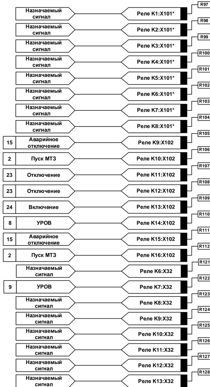
\*При использовании схемы разделения на физическом уровне подсетей GOOSE и MMS стандарта МЭК 61850-8.1 клемма X101 отсутствует (см. рисунок 35.2)
