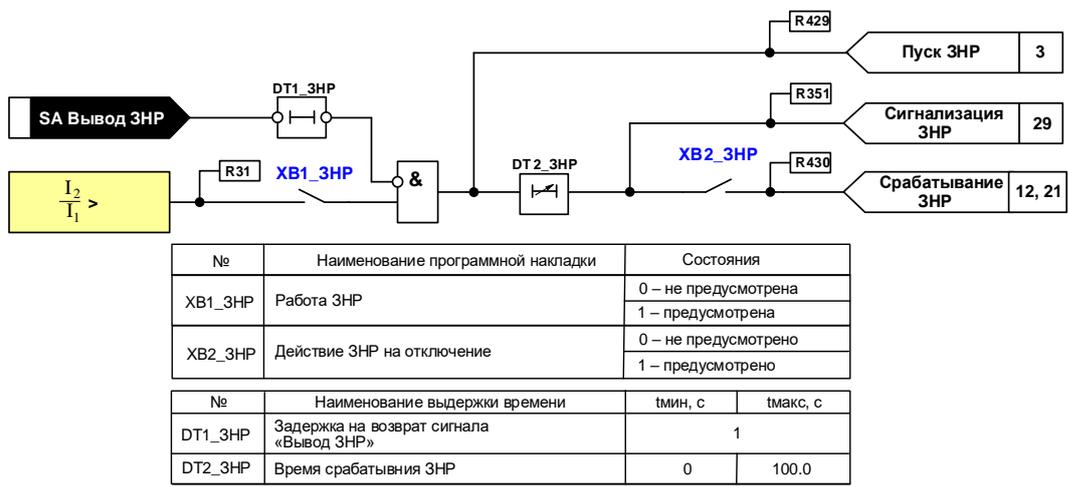
Рисунок 6 – Функциональная схема ЗНР
