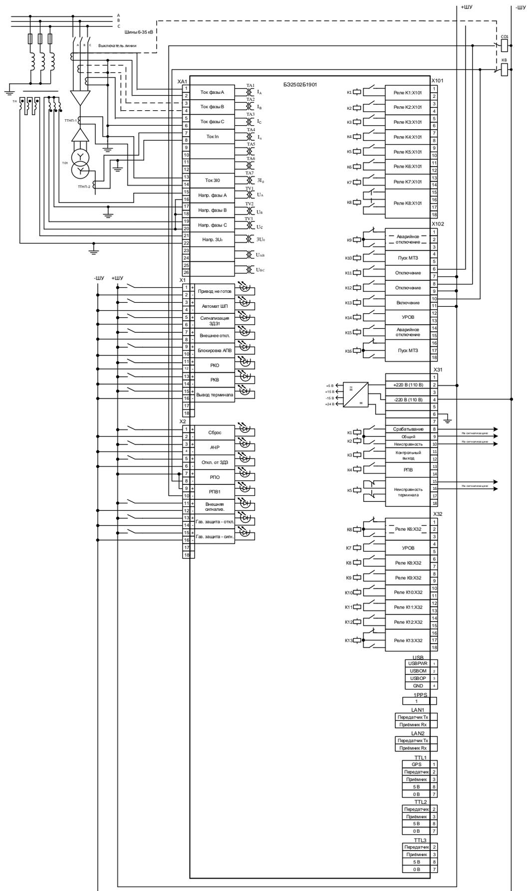
Рисунок В.3 – Пример подключения внешних цепей к терминалу БЭ2502Б1901
