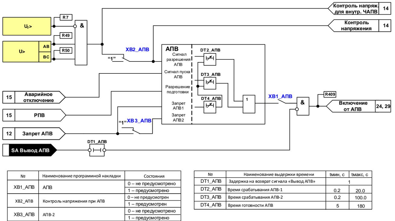
Рисунок 13 – Функциональная схема АПВ
