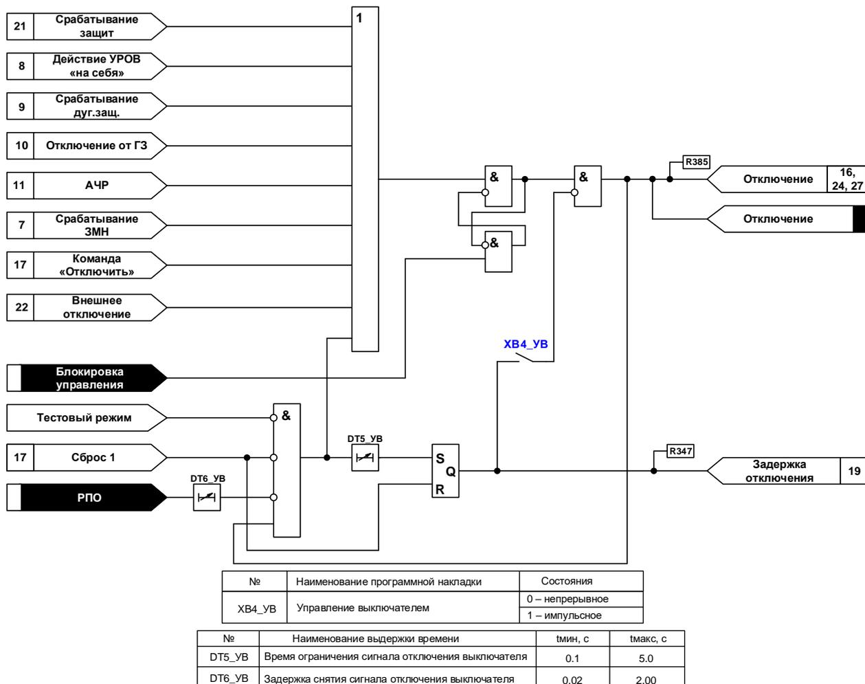
Рисунок 23 – Функциональная схема цепей отключения
