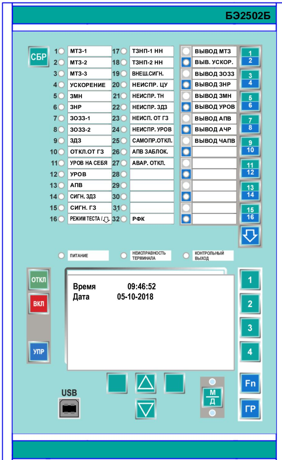
Рисунок Б.1 – Расположение элементов на лицевой панели терминала БЭ2502Б1901
