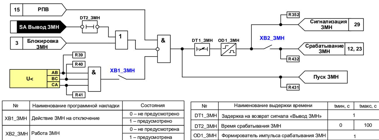
Рисунок 7 – Функциональная схема ЗМН
