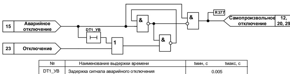
Рисунок 16 – Функциональная схема формирования сигнала самопроизвольного отключения
