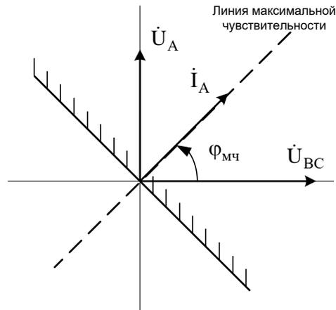
Рисунок 3 – Векторная диаграмма токов и напряжений, подаваемых на ИО направления мощности
