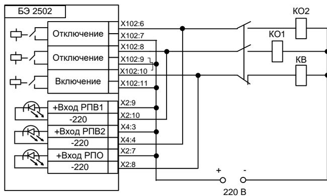
Рисунок 18 – Схема соединения цепей контроля положения выключателя
