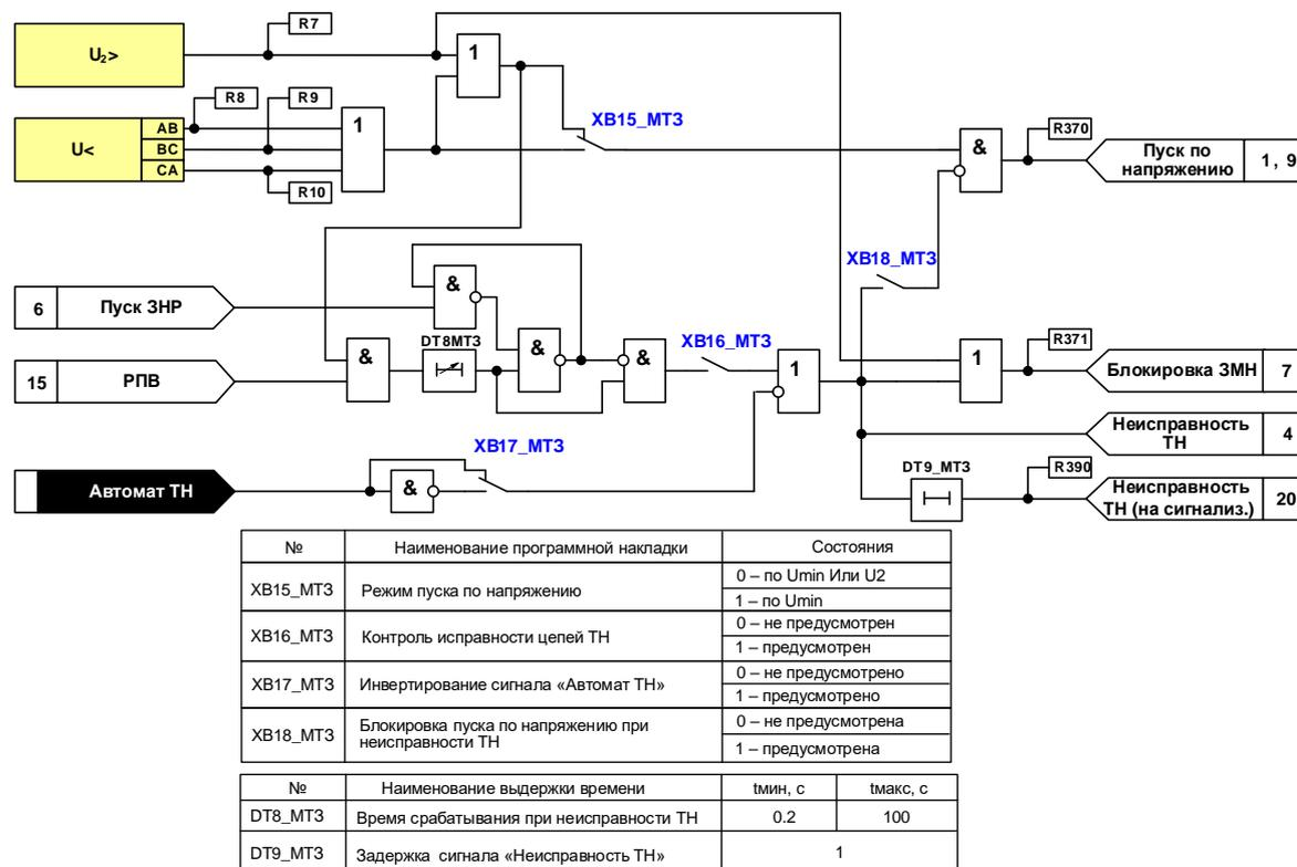
Рисунок 3 – Функциональная схема пуска по напряжению
